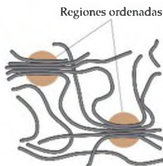
▲ Figura 12.25 Interacciones entre cadenas de polímeros. En las regiones circulares, las fuerzas que operan entre segmentos de cadenas poliméricas adyacentes dan lugar a un ordenamiento análogo al de los cristales, aunque menos regular.
